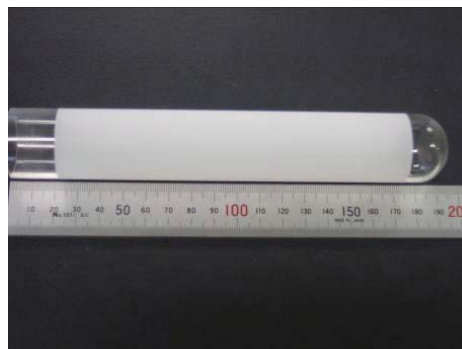
開発した光触媒被覆円筒形状ガラス
