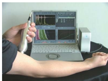
超音波弾性評価装置で脂肪、各筋肉の硬さを測定している様子
