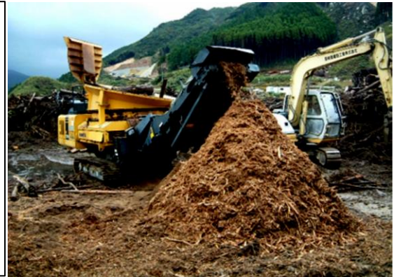
[木材破砕材をウッドチップ化する作業の1工程]
