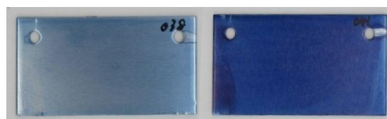
天然藍によるアルマイト染色例 —染色回数による色制御—
